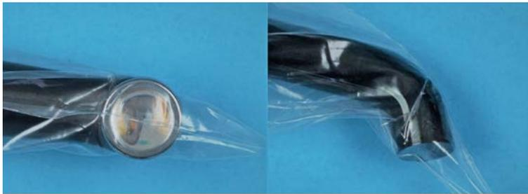
Abb. 3: Einfluss auf Strahlungsstärke: Ungünstig angelegte Schutzfolien, die die Bestrahlungsstärke negativ beeinträchtigen.
